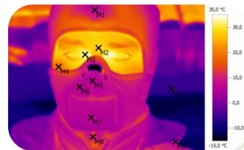
Термограмма, используемая для исследования возможных тепловых потерь через маску
