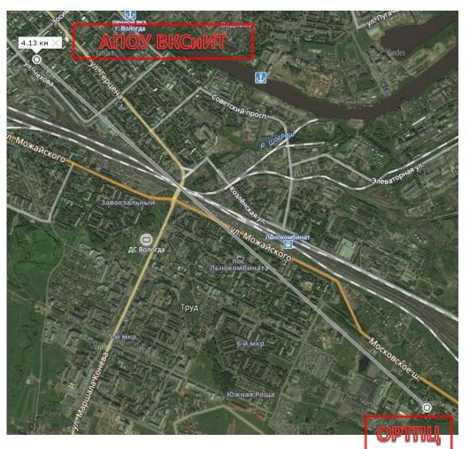
Точка измерений №1 Адрес: ул. Первомайская, д. 42. АПОУ ВКСиИТ Расстояние: 4, 13 км Условия: прием отраженного сигнала от жилого дома Измерительный прибор: Анализатор спектра ROHDE&SHWARTS ESPI
