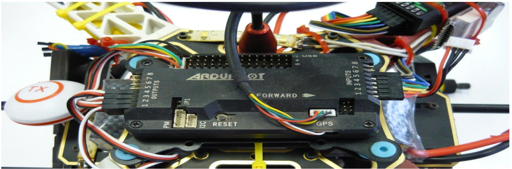
**Полетный контроллер ArduPilot Mega является главной частью БПЛА (Беспилотного Летящего аппарата UAV), который позволяет помимо радиоуправляемого дистанционного пилотирования осуществлять автоматическое управление по заранее созданному маршруту, т.е. полет по точкам, а так же обладает возможностью двухсторонней передачи телеметрических данных с борта на наземную станцию (телефон, планшет, ноутбук, DIY) и ведение журнала во встроенной памяти.**
